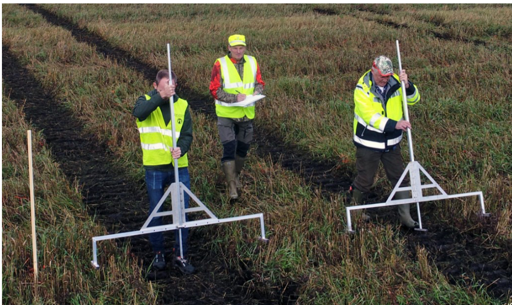
Figur 7. Spårdjupet mäts på de raka banorna.
