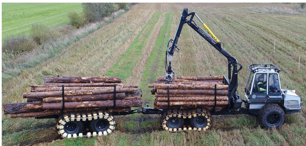
Figur 5. Malwa 560 F utrustad med trailer (vikt 800 kg) och kompositband under spårdjupstest 2017.
