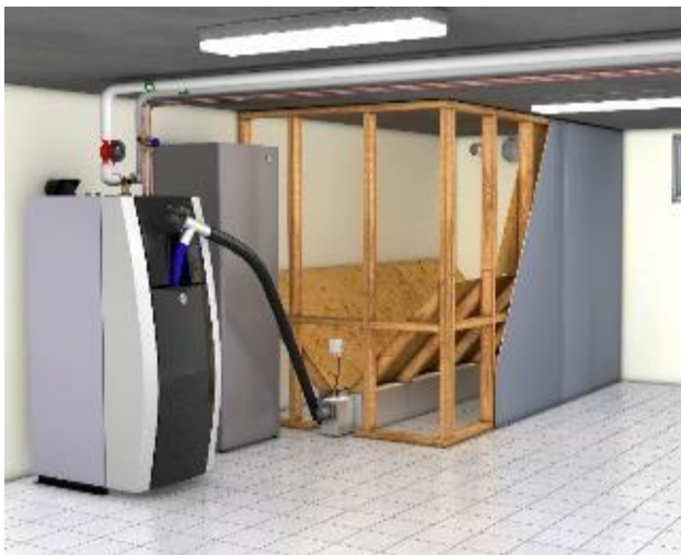
Bild 18. Det går utmärkt att platsbygga ett pelletsförråd men är du som installatör osäker hur du skall göra bör du låta en byggfackman ge dig råd angående materialval och dimensionering av reglar, skivor mm.
