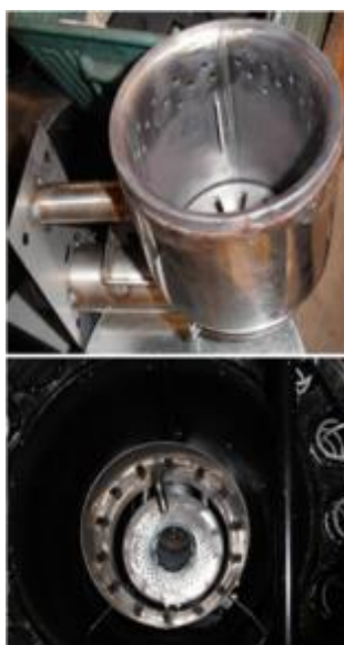
Bild 54. Ex på brännarhuvuden från Windhager (överst) och Ökofen nederst
