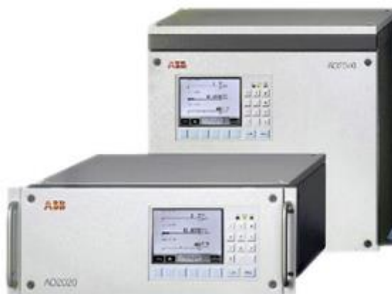
Bild 104. Andelen oförbrända kolatomer (THC) analyseras lämpligen i ett flamjoniseringsinstrument. Dessa instrument är oftast stationära i ett labb då de både är dyra i inköp och drift och besvärliga att ta med ut i fält.
