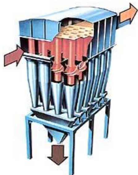
Bild 118. Exempel på hur en multicyklon ser ut i genomskärning
