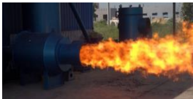
Bild 114. Lågan från en pulverbrännare är lik en oljelåga varför tekniken passa utmärkt att konvertera till befintliga oljepannor
