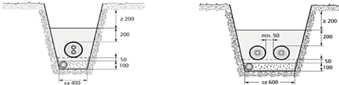
Bild 81. Schaktning och fyllning ska följa anvisningar i referensverket Anläggnings-AMA. De båda bilderna visar även hur rörgravarna dräneras, om det behövs. (Källa: Uponor)
