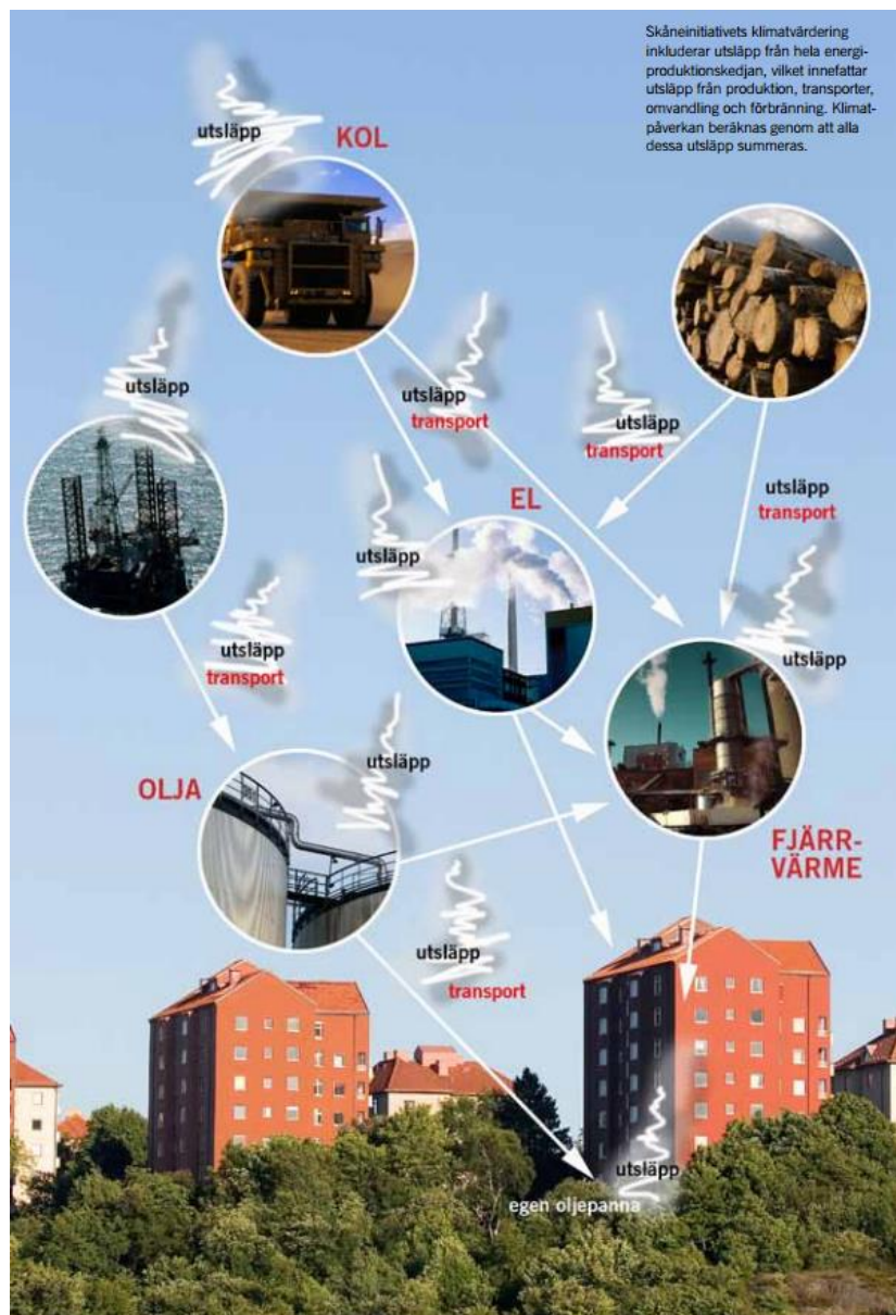
Bild 124. Skåneinitiativets klimatvärdering inkluderar utsläpp från hela energiproduktionskedjan, vilket innefattar utsläpp från produktion, transporter, omvandling och förbränning. Klimatpåverkan beräknas genom att alla dessa utsläpp summeras
