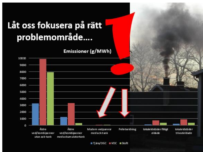
Bild 7. Större delen av de nu aktuella utsläppen uppkommer som ett resultat av ofullständig förbränning i gamla vedpannor, som saknar en ackumulatortank där värmen kan lagras.
