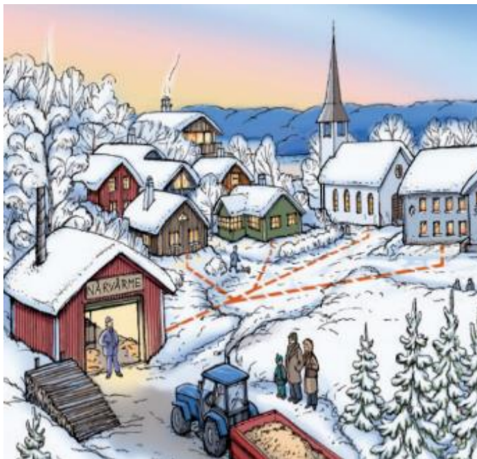
Bild 110. En närvärmeanläggning innebär att ett antal husägare går ihop och ersätter sina individuella uppvärmningssystem med en gemensamt ägd värmeanläggning, ett mindre fjärrvärmenät.
