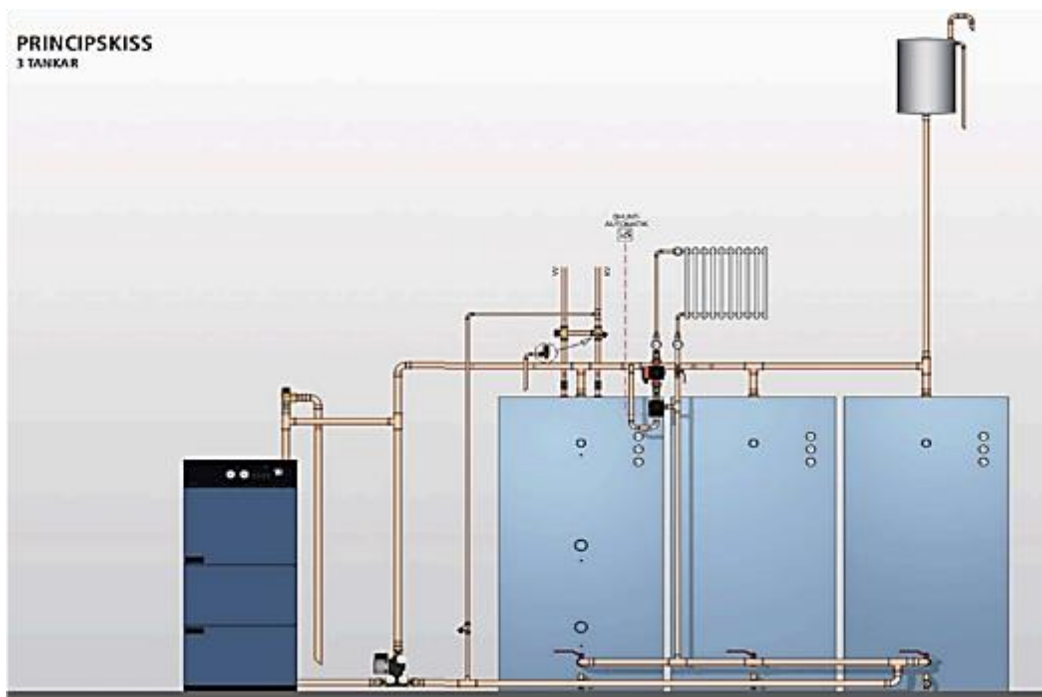
Bild 76. Figuren visar standardkoppling med tre stycken parallellkopplade ackumulatortankar.
