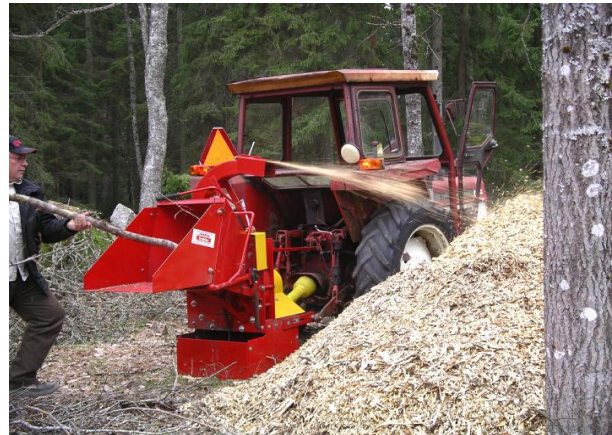
Bild 9. Jinma Flishugg är ett exempel på traktordrivet aggre-gat för mindre användare
