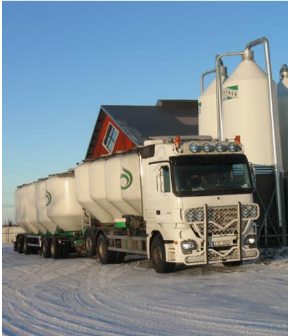
Bild 13. En fullastad bulkbil tar 35 ton pellets vilket motsvarar 168 000 kWh, vilket är årsbehovet för 6- 8 normala villor
