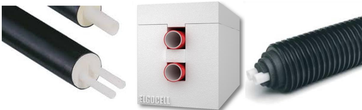
Bild 79. Kulverten kan ha lite olika konstruktion och utseende. Huvudkomponenterna är ledningsrör, även kallat mediarör, och isolering. Fabrikstillverkade kulvertar har ett mantelrör som yttre skydd, men andra konstruktioner finns. Mantelröret kan vara korrugerat som i bild till höger eller slätt. Det korrugerade röret är lättare att böja.
