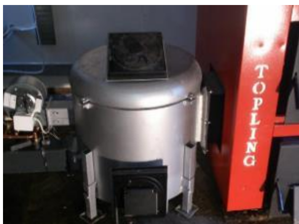
Bild 60. Ett exempel på en bra förugn från Swebo Flis AB
