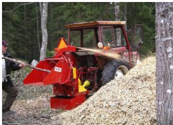
Bild 9. Jinma Flishugg är ett exempel på traktordrivet aggregat för mindre användare
