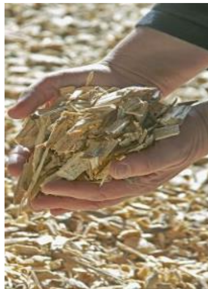
Bild 10. Bilden visar hur en bra kvalitet på flis kan se ut.
