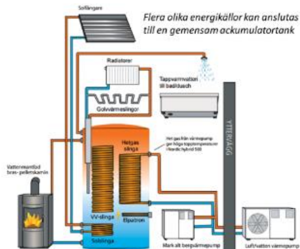
Bild 57. Exempel på kombination med vattenmantlad pelletskamin solfångare och/eller luftvärmepump.
