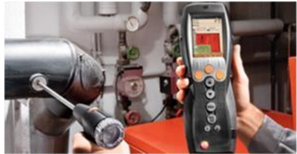
Bild 100. Bilden visar en rökgasanalys som genomförs hemma hos kunden med hjälp av ett handinstrument.
