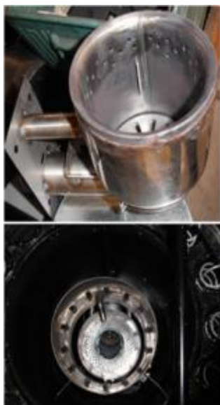
Bild 54. Ex på brännarhuvuden från Windhager (överst) och Ökofen nederst
