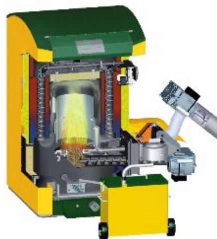
Bild 55. KWB helautomatisk pelletspanna är ett exempel på modernaste teknik för pelletseldning i villa på marknaden
