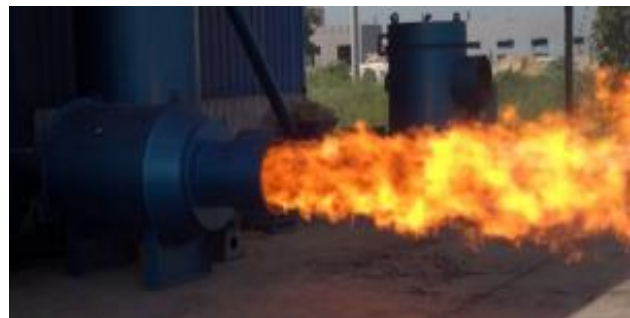
Bild 114. Lågan från en pulverbrännare är lik en oljelåga varför tekniken passa utmärkt att konvertera till befintliga oljepannor
