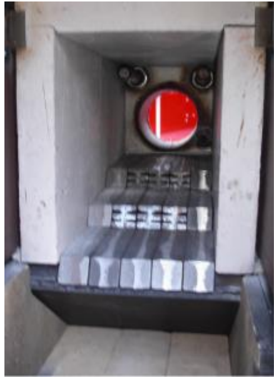
Bild 113. Reka-pannan är ett exempel på en mindre panna med rörligt trapprost.
