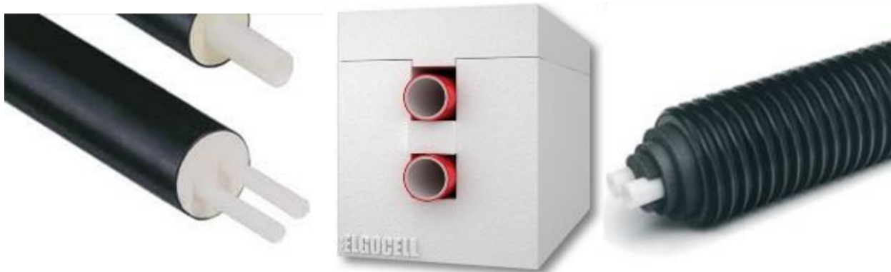
Bild 79. Kulverten kan ha lite olika konstruktion och utseende. Huvudkomponenterna är ledningsrör, även kallat mediarör, och isolering. Fabrikstillverkade kulvertar har ett mantelrör som yttre skydd, men andra konstruktioner finns. Mantelröret kan vara korrummerat som i bild till höger eller slätt. Det korrummerade röret är lättare att böja.
