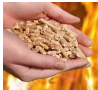
Bild 49. Pellets är hårt pressad sågspån, normalt med en diameter på 6- 8 mm
