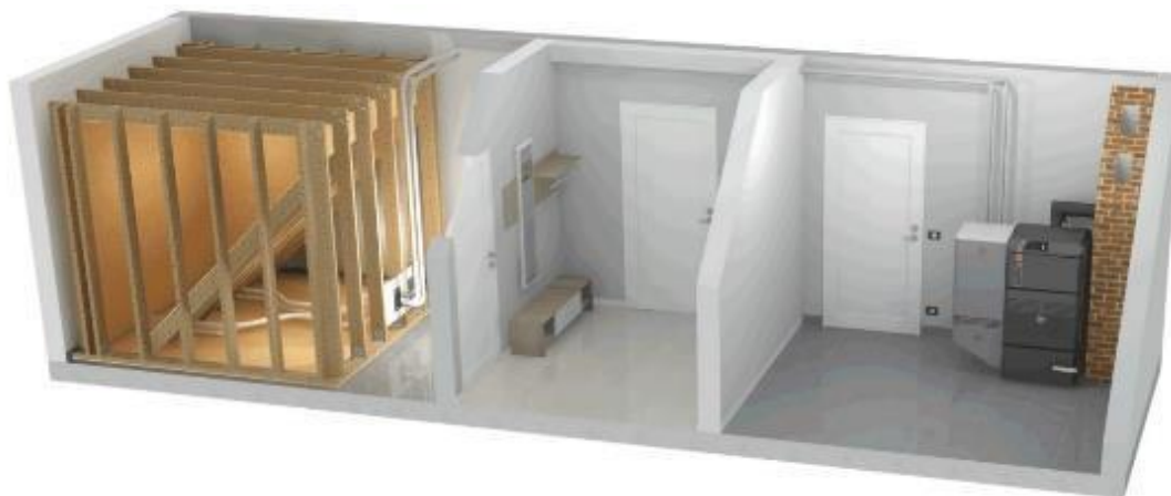
Bild 19. Matningen av pellets från förrådet till pannan kan ske med skruvar eller som bilen ovan med hjälp av sugdysor och vakuumsug.
